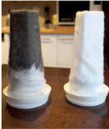
Jos kodin ilmanvaihdon suodattimia ei vaihdeta ja venttiileitä puhdisteta, sisäilman laatu heikkenee!
